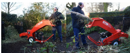
Equippé avec la goulotte haute (éjection en hauteur)
