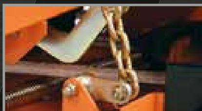
Système de réglage du plateau de coupe sur les quatre côtés, garantissant des réglages aisés pour une tonte régulière.
