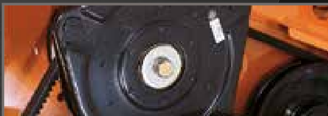
L'embrayage de lame Ogura 3.5 ou GT 5 et le frein de lame sont installés selon la puissance du moteur. Intervalle réglable pour une meilleure longévité.
