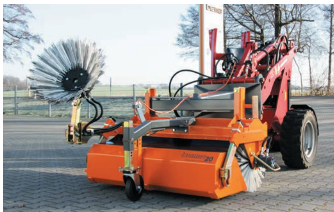
Vidage du bac de ramassage par câble (mécaniquement), Brosse latérale
