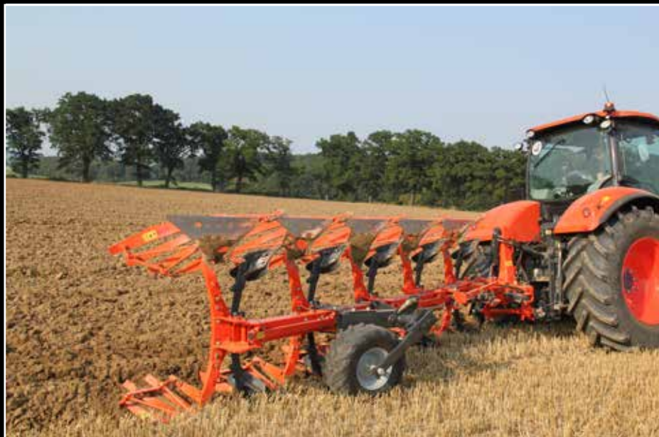
RM3000V: Sécurité par boulon de cisaillement, Varilarge®.
