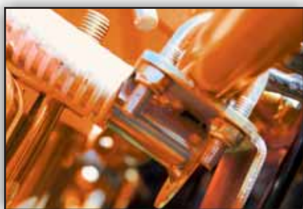
La sortie de distribution est située devant le rouleau. La position et l'angle sont réglables.
