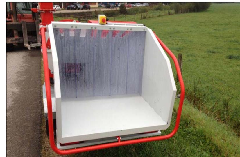
Barre de commande avant — stop — arrière avec bouton d'arrêt d'urgence pour travailler en toute sécurité.
