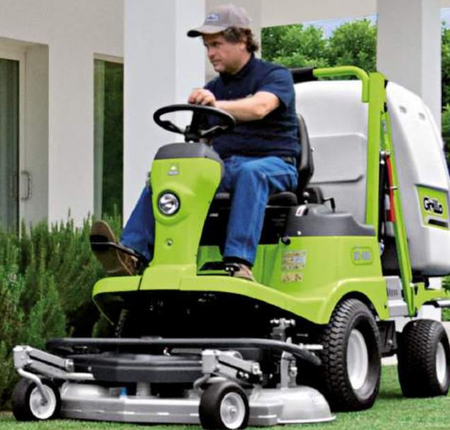
**La capacité du bac est de 450 lt**, la vidange est à commande électro-hydraulique et arrive jusqu'à 170 cm. En plus le réglage électrique en continu de la hauteur de coupe permet de choisir rapidement et au millimètre la meilleure position pour une parfaite finition.
