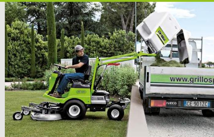
En fin de travaux, le **nettoyage** du plateau est facile et rapide: connectez le tuyau d'eau à la prise de lavage prévue sur le plateau, mettez en route les lames pour quelques secondes...et plateau et canal sont de nouveau propres.
