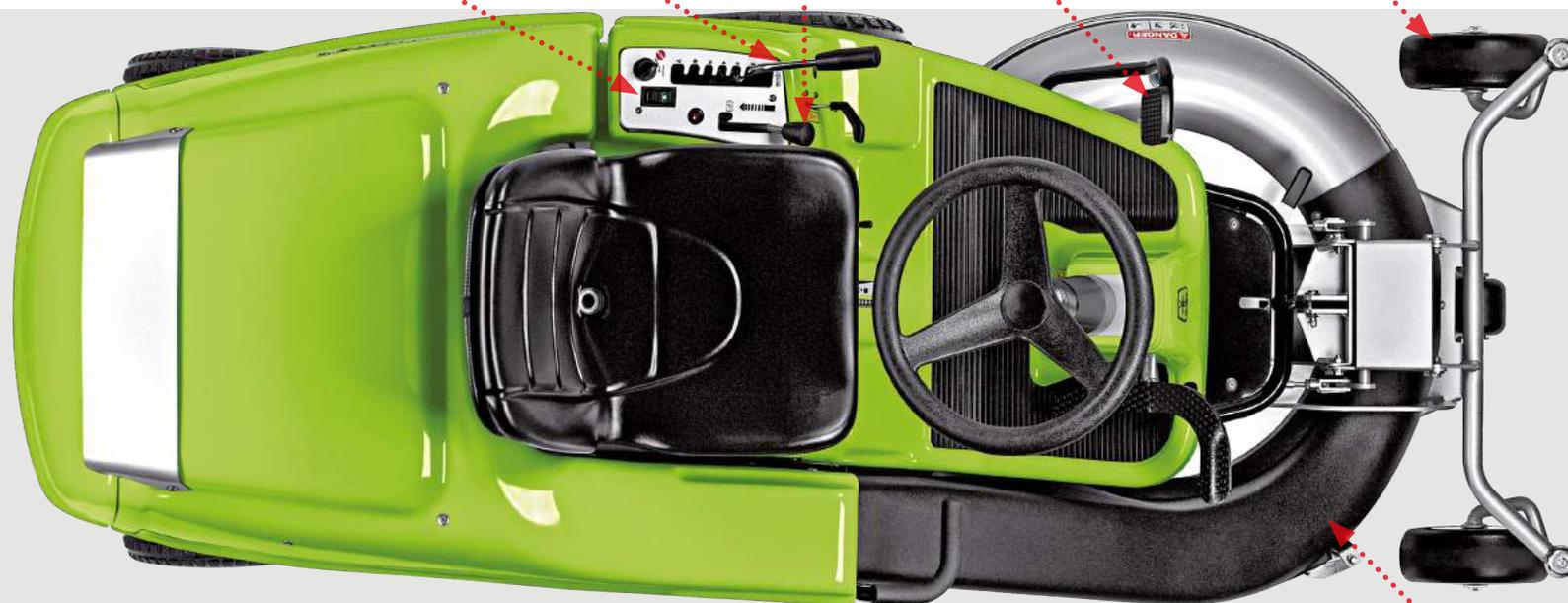
Le **frein de stationnement** est à disque et commandé par un pratique levier « actif » qui permet de descendre de la machine tout en laissant le moteur tourner, à condition que les lames soient débrayées (système de sécurité maximal).
