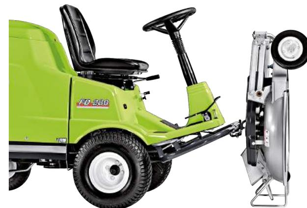
Le **plateau** de la FD 280 est facilement démontable pour être positionné d'une manière stable à la verticale sur 2 supports intégrés dans le châssis du plateau: il suffit juste d'enlever la courroie de transmission en agissant sur une commande rapide pour rendre immédiat tout type d'entretien et manutention.
